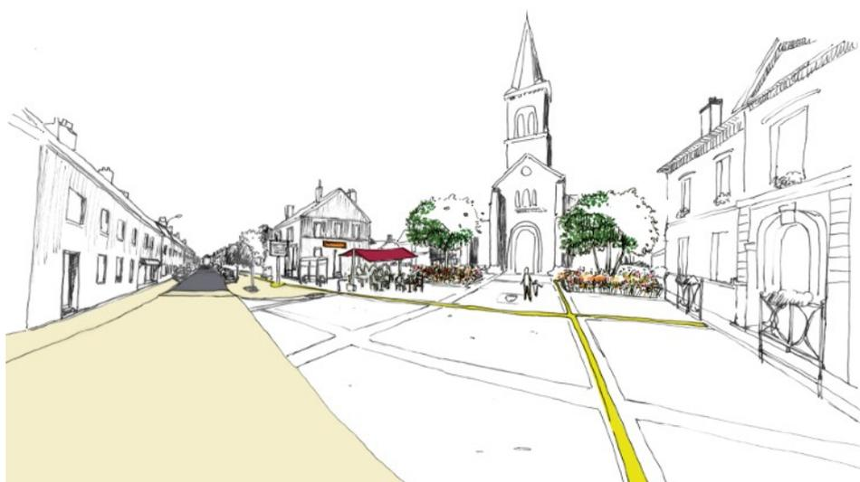
Illustration de la place de la Mairie : la rue est marquée par un traitement au sol différent, en lien avec les trottoirs et la place, mettant le piéton en avant. Le stationnement est optimisé sur la place, permettant d'imaginer de nouveaux usages, conduits par le fil de Châtillon
